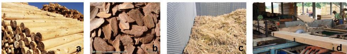
Figura 3 – Resíduos de madeira industrial de tamanhos variados: rolete (a), casca (b), aparas (c); processo de destopo (d)
