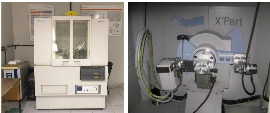
Figura 26 – Difratômetro de raios X X'Pert PRO MPD da PANanalytical instalado no Laboratório de Análises por Raio X da UEL.
