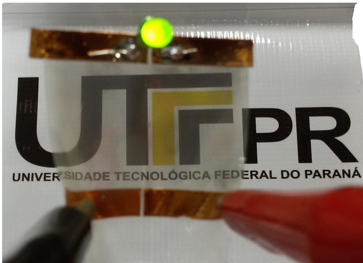
Figura 49 – Filme condutor, transparente e flexível depositado sobre PET. A corrente elétrica atravessa o filme para acender um LED comercial.
