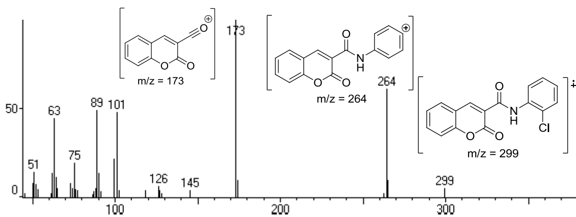
Figura 16C – Espectro de massas do composto 3h por espectrômetro de massas acoplado a cromatografia gasosa (CG-EM)
