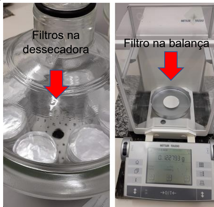
Figura 9 – Ambientação de filtros na dessecadora e balança ultra analítica para determinação gravimétrica
