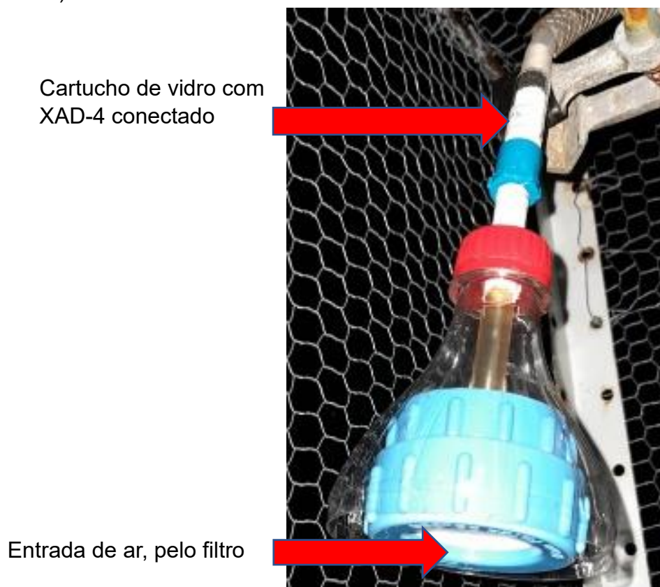
Figura 6 – Amostrador da fase gasosa. Disposição do filtro de particulado total (entrada) e do cartucho recheado com XAD-4
