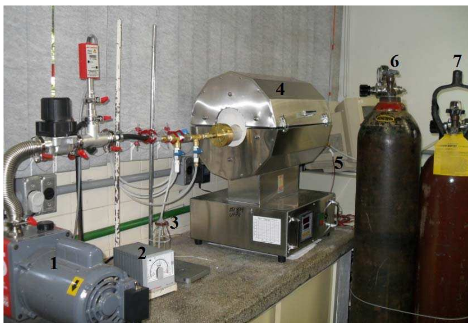
Figura 2-2 – Montagem experimental para o tratamento térmico, onde (1) bomba de vácuo mecânica, (2) medidor de vácuo, (3) controlador de fluxo de gás, (4) forno, (5) fio do termopar, (6) e (7) cilindros de oxigênio e argônio, respectivamente.
