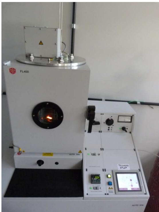
Figura 2-1 – Sistema de deposição HHV (AUTO 306) com a barca de evaporação sendo aquecida.
