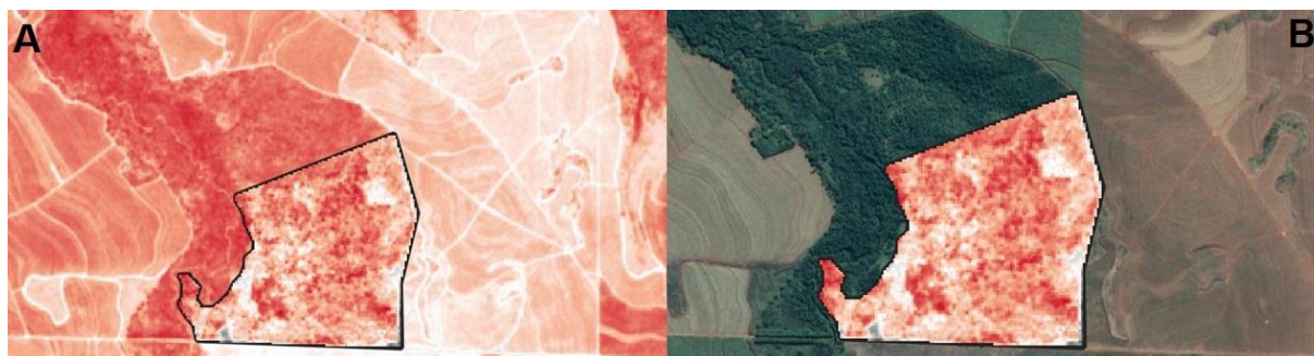
Figura 3: A imagem A representa o polígono (contornado com linha preta) antes do isolamento do NDVI para o seu interior. Em B temos o resultado do procedimento, com o NDVI isolado somente para o interior do polígono de interesse.
