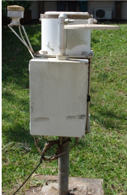
Figura 6- Coletor úmido automático (Eigenbrodt-D-2III-Königsmoor UNS 130).
