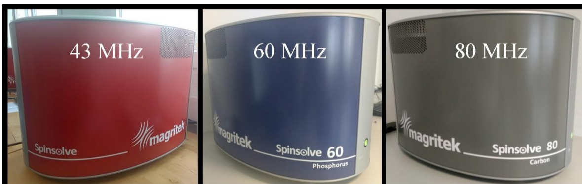
Figura 27 – Configurações de espectrômetros de RMN de bancada utilizados.
