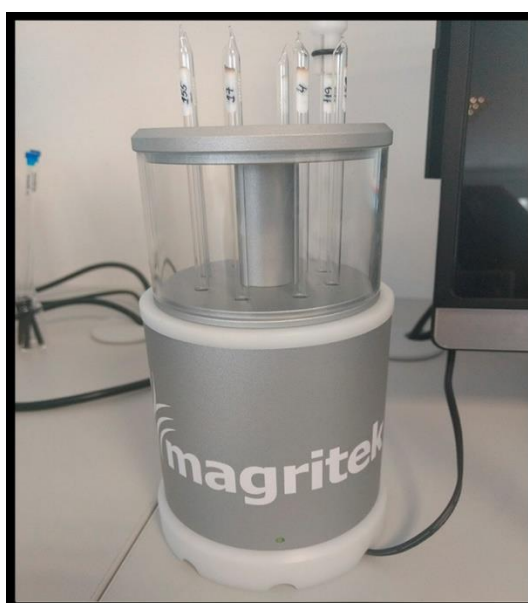
Figura 28 – Estabilizador de temperatura para tubos de RMN.
