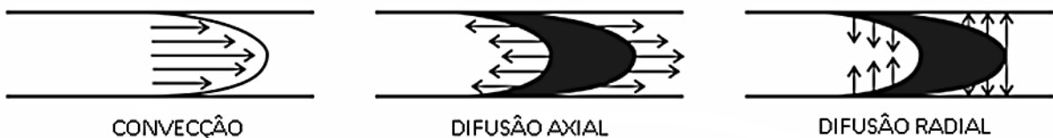
Figura 20 - Representação dos fenômenos de convecção, difusão axial e radial no sistema SIA.
