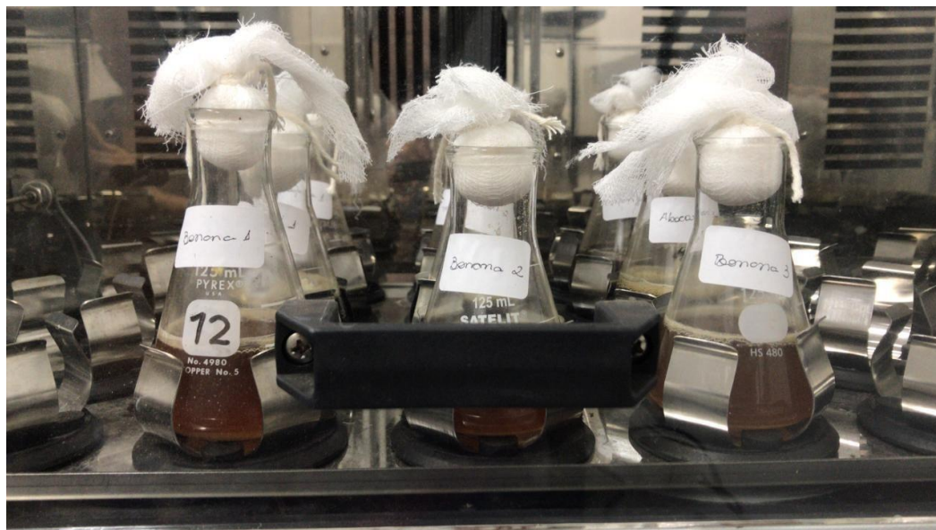
Figura 1. Erlenmeyers incubados no shaker por 12h a 30 °C sob agitação.
