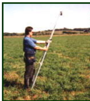
Figura 3 – Radiômetro de múltiplo espectro em uso no campo
