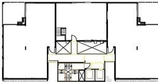
Figura 21 – Ed. 4x4, pavimento tipo composto por três plantas flexíveis, sendo a do meio duplex.
