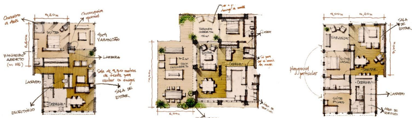
Figura 32 – Ed. 4x4, opções de ocupação da planta flexível conforme o modelo tripartido.
