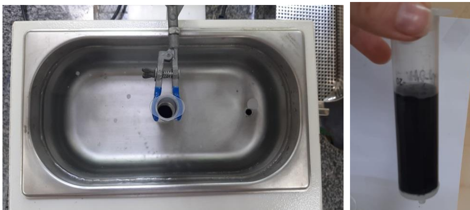
Figura 4-1 - Fotografia do sistema de pré-concentração de íons Pb 2+ usando ISd-SPE.
