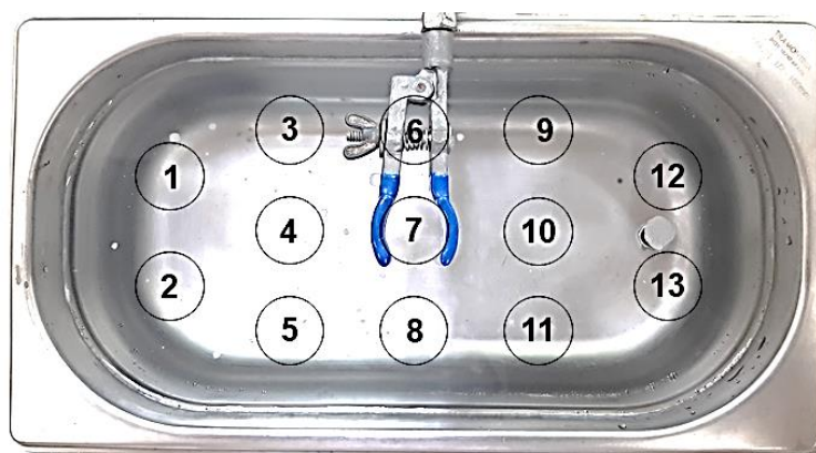
Figura 4-5 – Fotografia do banho ultrassônico com as posições indicadas pelos números de 1 a 13.
