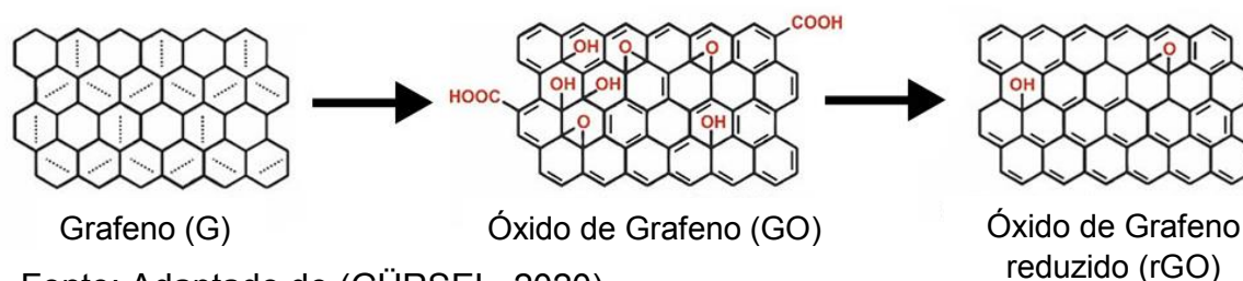
Figura 2-3 - Ilustração da estrutura do grafeno (G), grafeno oxidado (GO) e grafeno reduzido (rGO).
