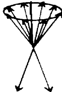
Figura 4 – Dipolos magnéticos alinhados na direção de \vec{H}
