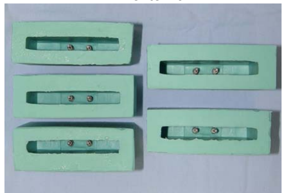
Figura 38 – Molde de silicone contendo os implantes hexágono externo.
