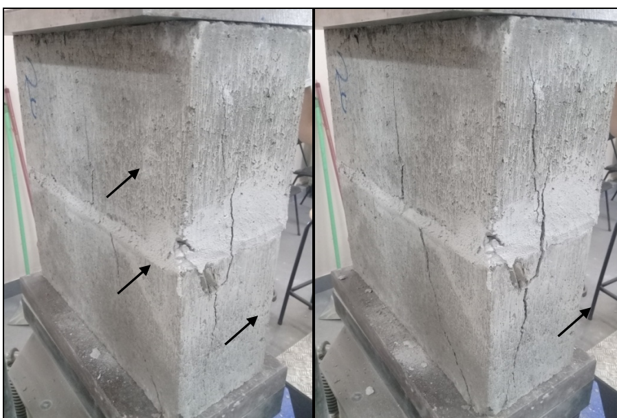
Figura 39 - Ruptura do prisma (M_C1)
