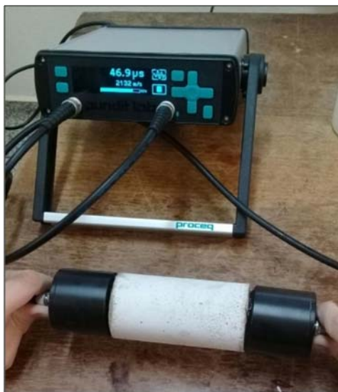
Figura 23 – Execução do ensaio para determinação do módulo de elasticidade dinâmico das argamassas ( Pundit lab )
