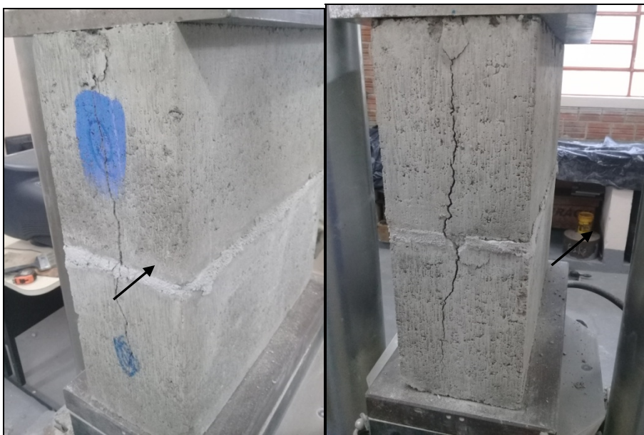
Figura 36 – Ruptura do prisma (M_B2)
