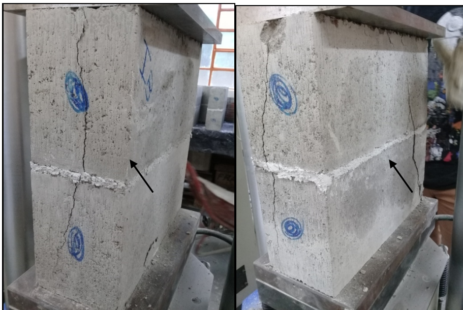
Figura 37 – Ruptura do prisma (I_B1)
