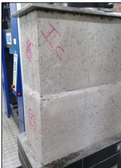
Figura 27 – Prisma submetido ao ensaio de resistência à compressão
