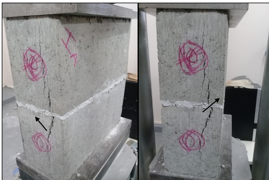
Figura 34 – Ruptura do prisma (I_A2)
