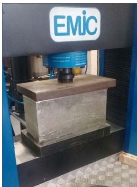
Figura 18 – Bloco de concreto submetido à compressão axial
