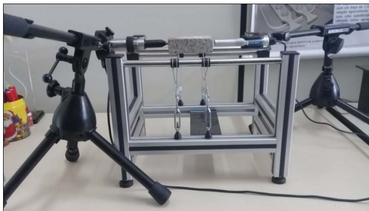
Figura 19 – Corpo de prova submetido ao ensaio para determinação do módulo de elasticidade
