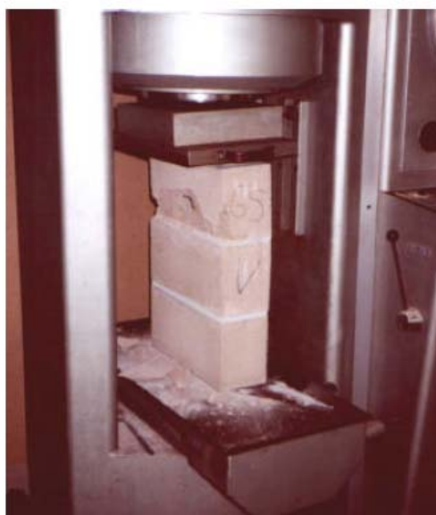
Figura 7 – Forma de ruptura dos prismas com argamassa industrializada
