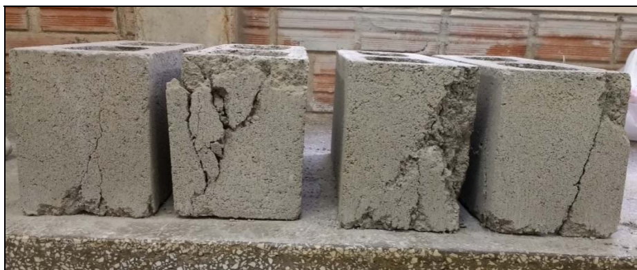
Figura 28 – Ruptura dos blocos submetidos ao ensaio de resistência à compressão axial
