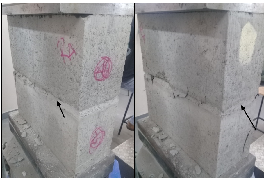
Figura 32 – Ruptura do prisma (M_A2)
