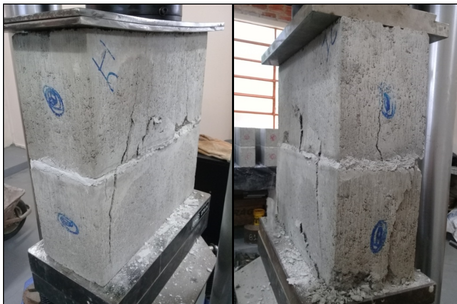
Figura 41 - Ruptura do prisma (I_C1)
