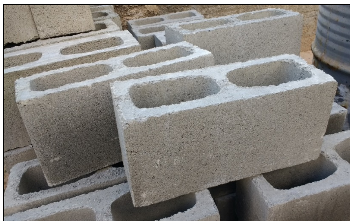
Figura 13 – Blocos de concreto
