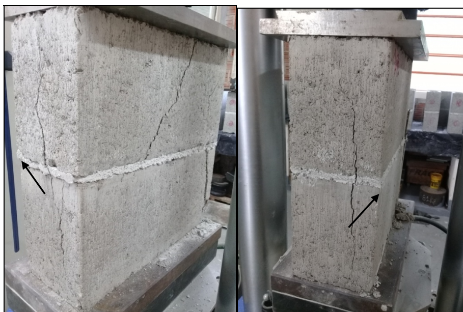
Figura 38 – Ruptura do prisma (I_B2)
