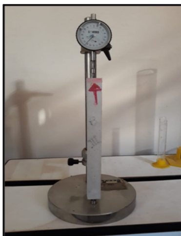
Figura 30 – Execução do ensaio de retração
