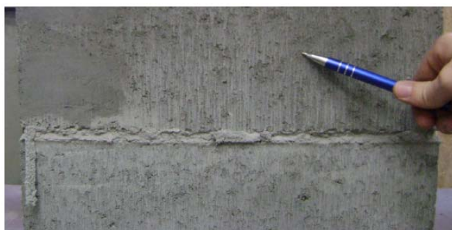
Figura 8 – Prisma com ruptura por esmagamento da junta
