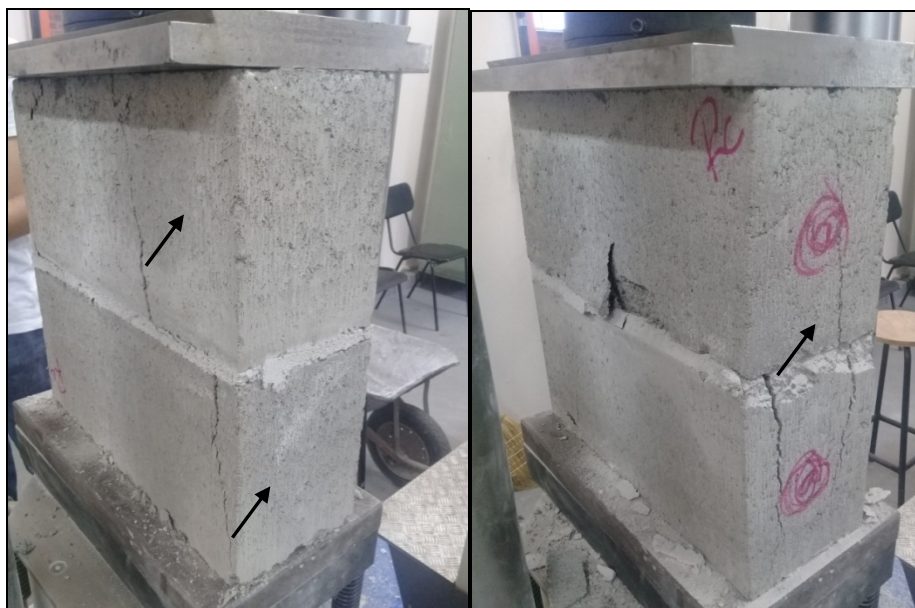
Figura 40 – Ruptura do prisma (M_C2)
