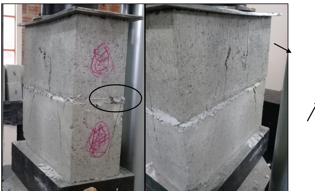
Figura 42 – Ruptura do prisma (I_C2)
