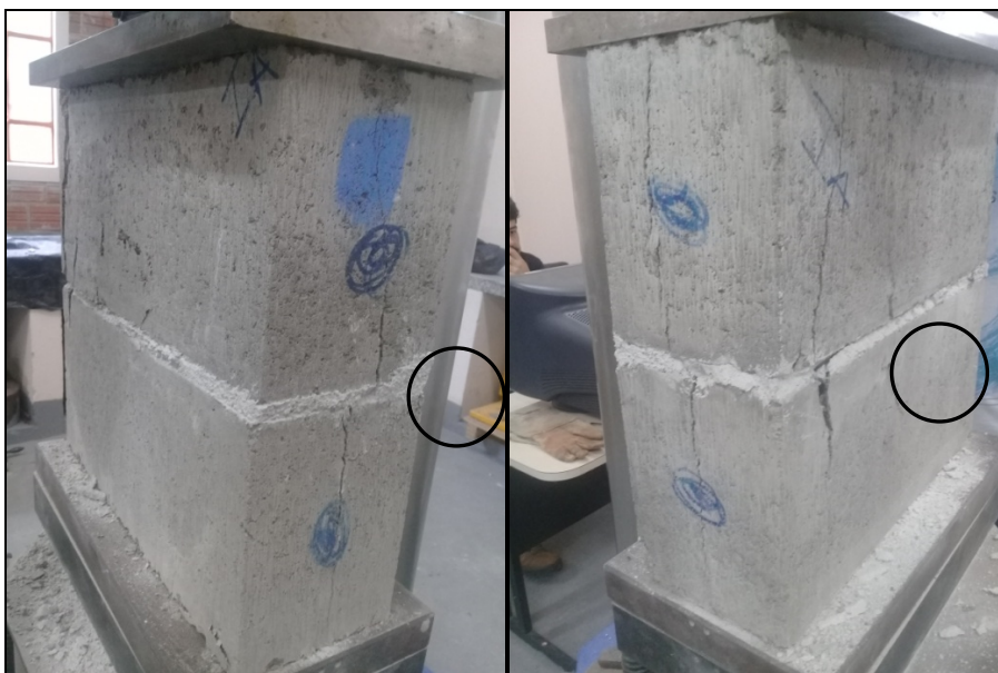
Figura 33 - Ruptura do prisma (I_A1)
