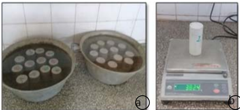
Figura 29 - Corpos de prova imersos (a) e pesagem do corpo de prova saturado (b) – Ensaio de absorção de água
