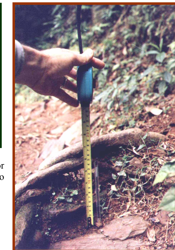
Foto 34 Canal de erosão, medida de profundidade e largura. Ajuda de turista
