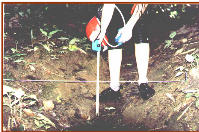
Foto 32 e 33 Medindo exposição de raízes causada por erosão em passagem que corta córrego que deságua no rio Betari.
