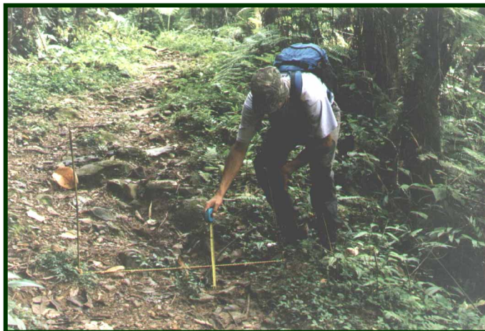
Foto 11 Medindo canais de erosão. Percebe-se a grande largura e insolação da trilha.
