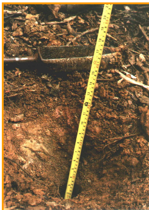
Foto 10 Medida de profundidade da tradagem.
