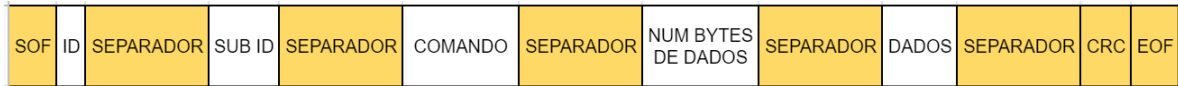
Figura 4.9 – Detalhamento do formato do protocolo serial (mensagens enviadas pelo computador/servidor ao medidor).
