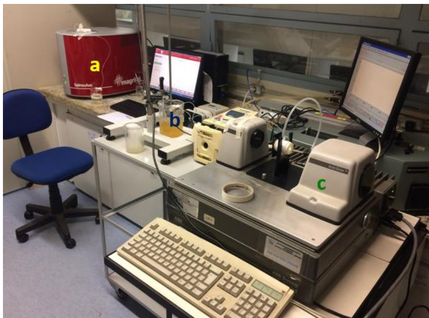
Figura 3.3 - Sistema para análise da reação de transesterificação. (a) LF- ^1\text{H} NMR; (b) Reator; (c) NIR.
