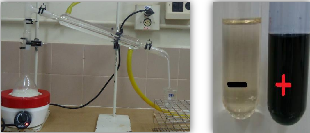
Figura 2. Sistema de destilação simples e a resultado da prova com ácido cromotrópico utilizado pelo método IN 68/2006
