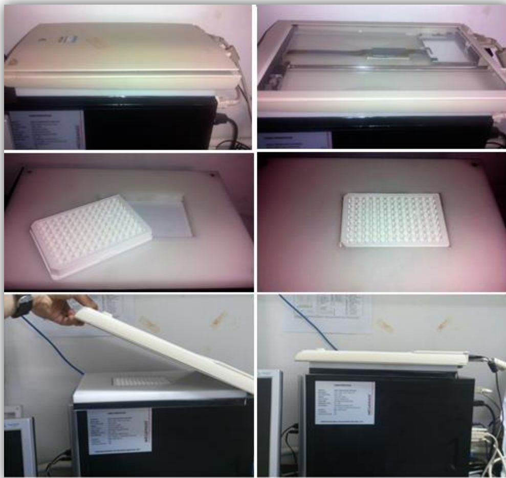
Figura 17. Parte interna do sistema instrumental para determinação de formol em leite, em que o scanner invertido está sob o suporte de polietileno ao redor da microplaca que contém as amostras
