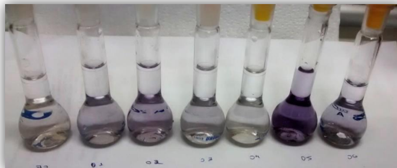
Figura 3. Um das replicatas dos pontos diluídos da curva analítica, após destilação simples e derivatização com ácido cromotrópico IN 68/2006
