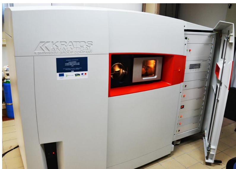
Figura 45 - Imagem do espectrômetro XPS (Kratos Analytical).
