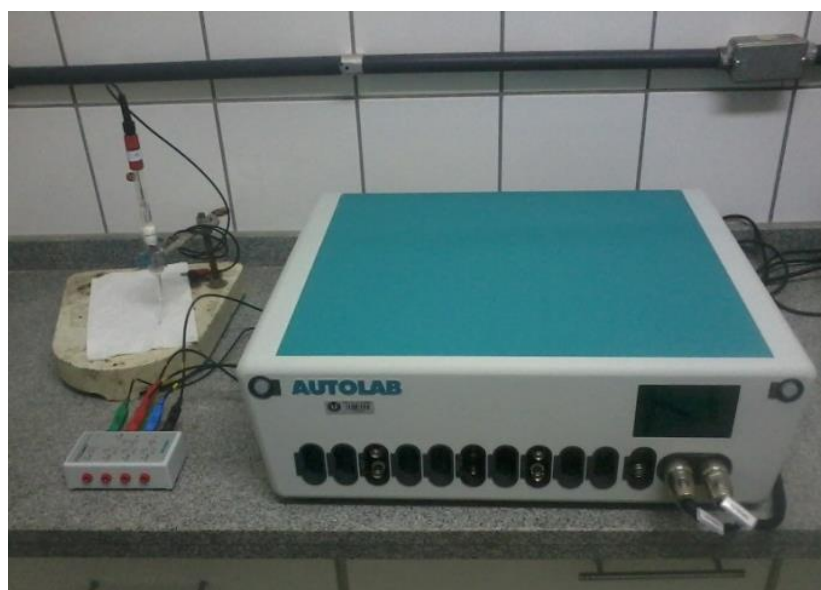
Figura 46 - Potenciostato/Galvanostato Autolab PGSTAT 302 N com módulo de impedância FRAM 32.
