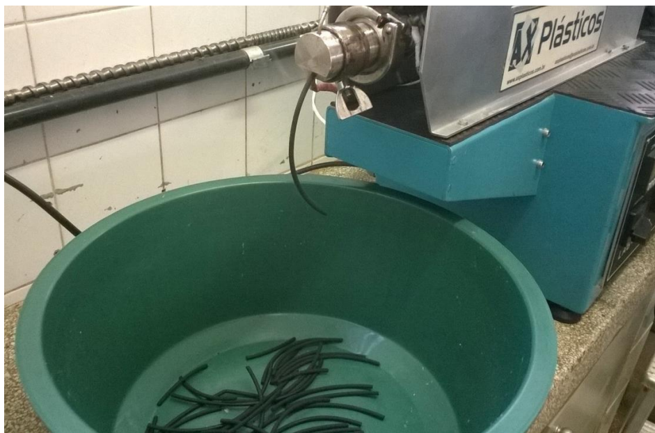
Figura 28. Produção de filamentos a partir de extrusão do pó de poliamida 66
