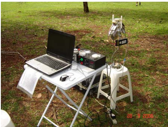
Figura 10 - Fotos da acomodação dos equipamentos para transporte ao local de amostragem (superior esquerda). Disposição dos equipamentos em um dos locais de amostragem (superior direita). Equipamentos de filtração e pré-concentração in situ (centrais). Sistema completo de EDXRF instalado em campo (inferiores)
