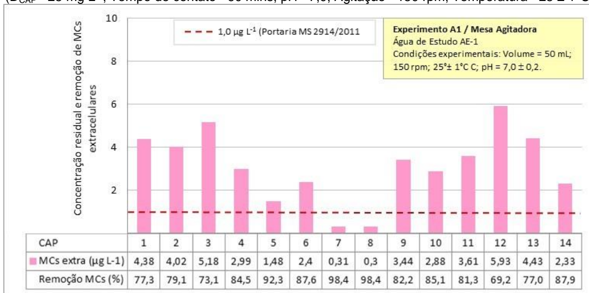
Gráfico 1 – Concentração residual de MCs e remoção para os CAPs amostrados / Experimento A1 . ( D_{CAP} = 25 \text{ mg L}^{-1} ; Tempo de contato= 60 mins; pH= 7,0; Agitação= 150 rpm; Temperatura= 25 \pm 1^\circ\text{C} )
