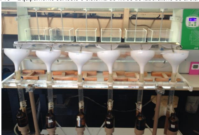
Figura 10 – Equipamento Jarteste e sistema de filtros de laboratório de areia – FLAs
