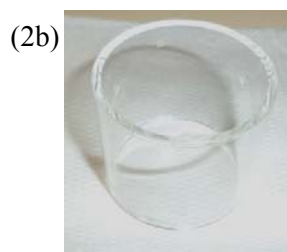
Figura 2. Cubeta com lente de quartzo com 5 cm de diâmetro (a) e cela com lente de vidro com 5 cm de diâmetro e 10 cm de altura (b)
