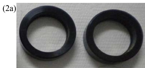
Figura 2. Cubeta com lente de quartzo com 5 cm de diâmetro (a) e cela com lente de vidro com 5 cm de diâmetro e 10 cm de altura (b)
