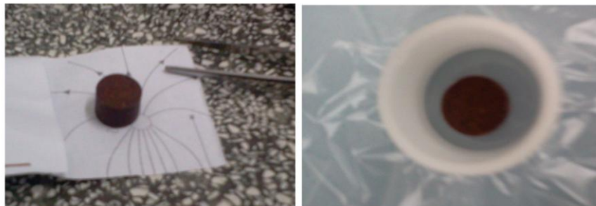
Figura 13 – Pastilha de banana desidratada produzida para a análise por fluorescência de raios X.
