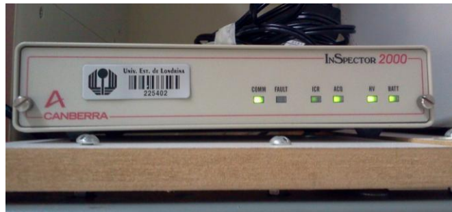
Figura 5 – Módulo eletrônico que corresponde à fonte de alta tensão, ao amplificador e a placa analisadora multicanal do sistema de espectrometria gama.
