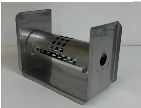
Figura 6. Tubo de restrição.
