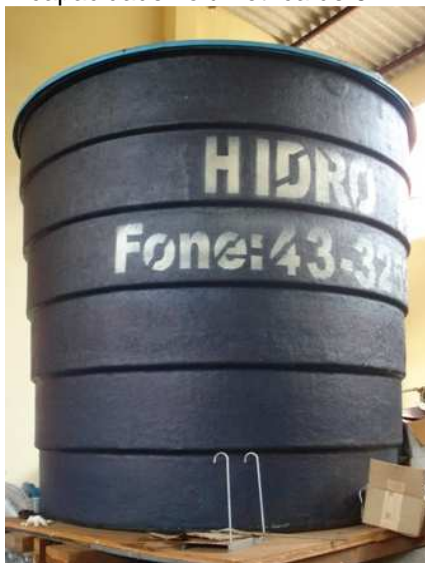
Figura 3 – Foto do reservatório de armazenamento e acondicionamento do lixiviado de estudo com capacidade volumétrica de 5 m 3
