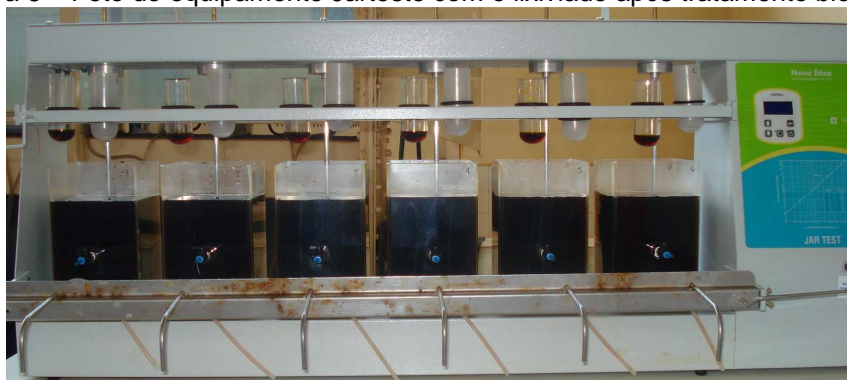
Figura 6 – Foto do equipamento Jarteste com o lixiviado após tratamento biológico
