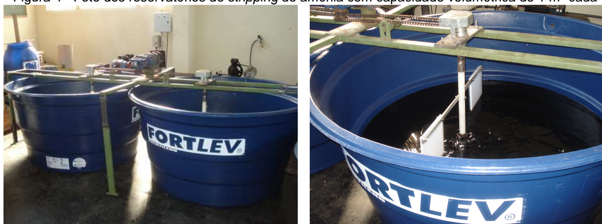
Figura 4 - Foto dos reservatórios de stripping de amônia com capacidade volumétrica de 1 m 3 cada
