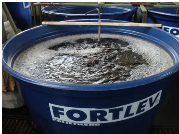
Figura 5 – Foto do reservatório do tratamento biológico na fase aeróbia com capacidade volumétrica de 1 m 3
