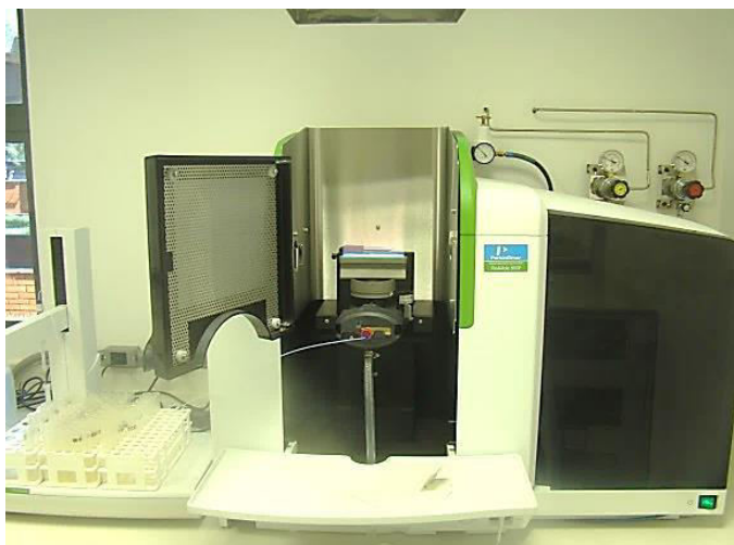
Figura 3 – Espectrofotômetro de absorção atômica da fabricante Perkin Elmer ® , modelo PinAAcle 900F.
