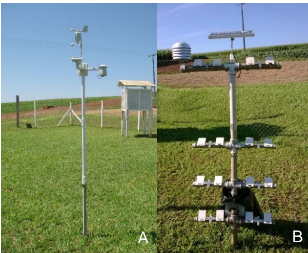
Figura 4.4 – Equipamentos instalados em estação agrometeorológica: A - Estação meteorológica; B – Árvore Eletrônica de Molhamento.
