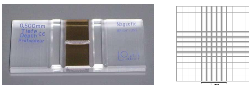
Figura 4. Câmara de Neubaer utilizada para contagem espermática. À esquerda, foto do modelo utilizado. À direita, representação esquemática da vista superior, através do microscópio, de um dos campos do aparelho
