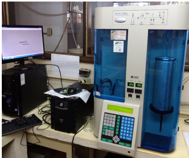
Figura 9 - Equipamento Quantachrome NOVA 1200e utilizado no ensaio de superfície específica BET.
