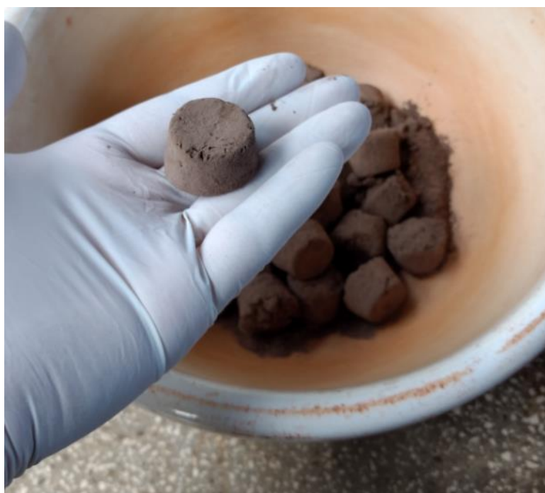
Figura 14 - CME calcinada à 800°C, apresentando início de aglomeração.
