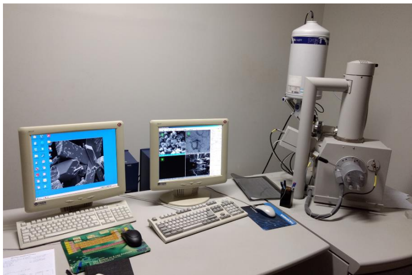
Figura 10 - Equipamento FEI Quanta 200 utilizado no ensaio de microscopia eletrônica de varredura.
