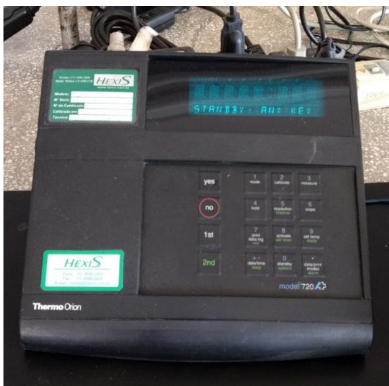
Figura 11 - Equipamento ThermoOrion 720A+ utilizado na medição do pH da CME.
