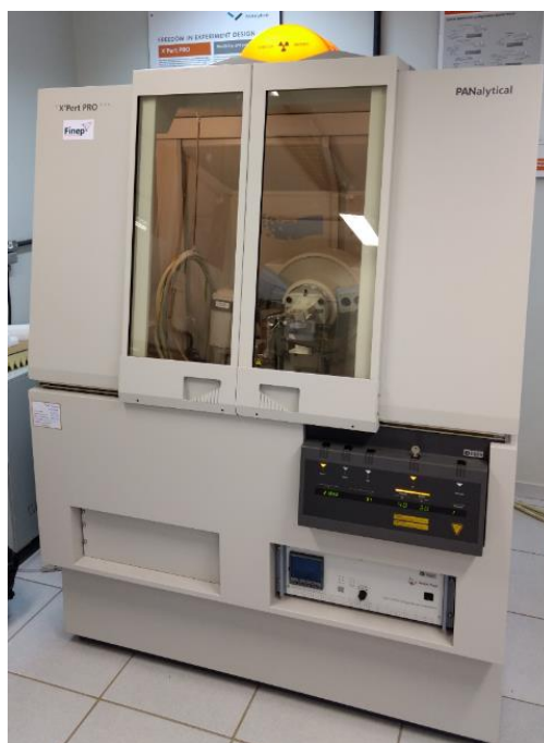
Figura 12 - Equipamento X'Pert PRO MPD utilizado na análise de difração de raios X.
