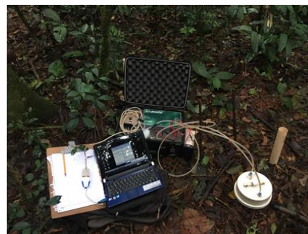
Figura 4. a. Modelo esquemático do método para amostragem da respiração do solo utilizando-se do IRGA acoplado à câmara. b. IRGA acoplado à câmara e computador pra a leitura de respiração do solo. (Fonte: O autor).
