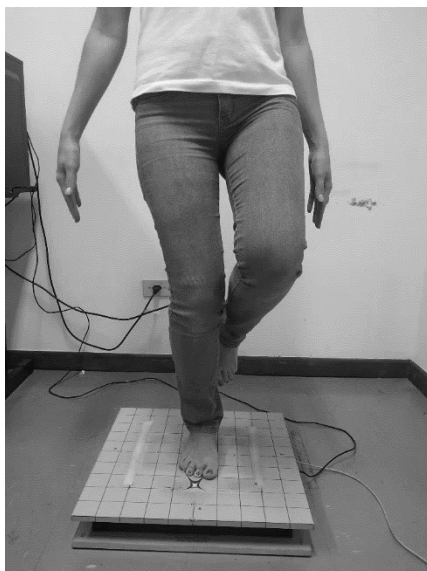
Figura 4 - Avaliação do equilíbrio por meio da plataforma de força.
