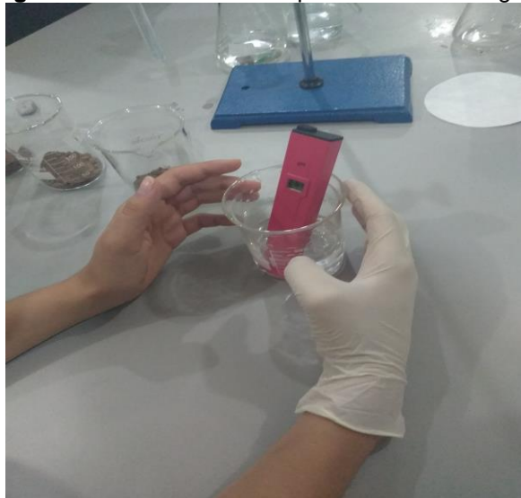
Figura 9 - Alunos medindo o pH com medidor digital
