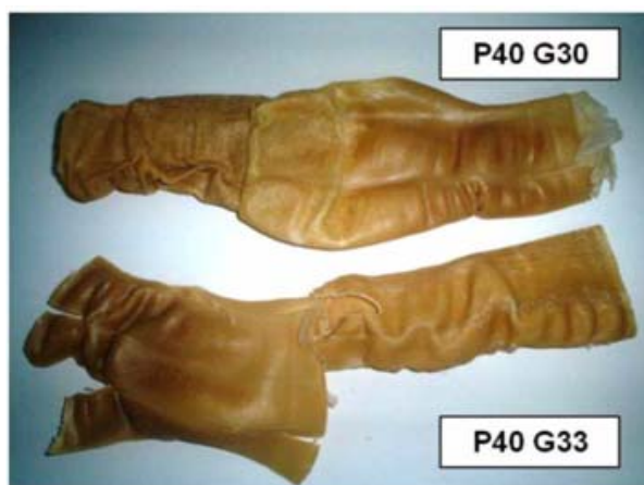
Figura 1 – Materiais biodegradáveis à base de farinha de aveia/PBAT/glicerol a partir da extrusão-sopro em balão
