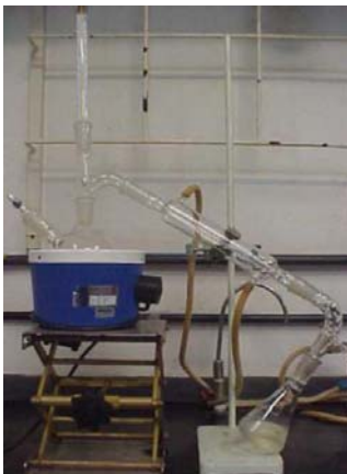
Figura 8 – Sistema para destilação fracionada do bio-óleo após esterificação.
