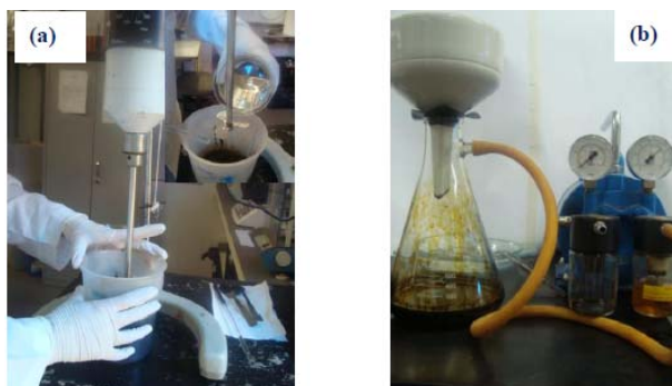
Figura 6 – (a) Sistema para agitação e solubilização do bio-óleo em álcool etílico. (b) Sistema para filtração.
