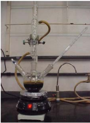
Figura 7 – Sistema para esterificação de ácidos orgânicos do bio-óleo.
