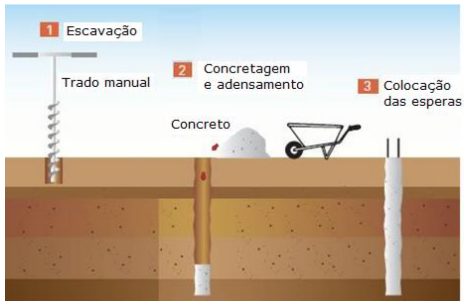
Figura 1 – Sequência executiva de estacas escavadas com trado manual.
