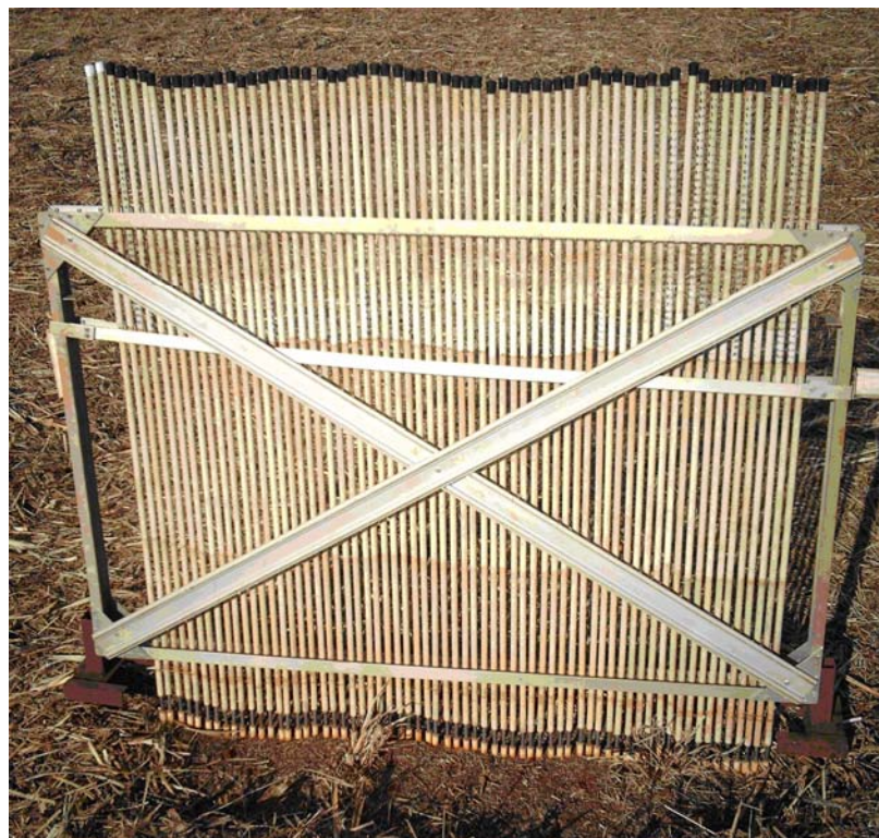
Figura 02 – Perfilômetro utilizado para avaliar os efeitos na linha de semeadura em função dos mecanismos de manejo da linha em semeadura direta.
