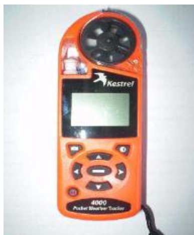
Figura 6 – Termoanemômetro (Marca Nielsen-Kellerman, Modelo Kestrel 4000) programado para monitorar e registrar as condições climáticas durante o transporte de frangos da granja ao abatedouro e descanso pré-abate.
