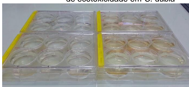
Figura 14 - Foto das diluições de uma das amostras, em placas de cultivo, para a realização do ensaio de ecotoxicidade em C. dubia
