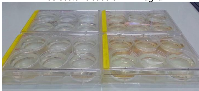
Figura 12 - Foto das diluições de uma das amostras, em placas de cultivo, para a realização do ensaio de ecotoxicidade em D. magna
