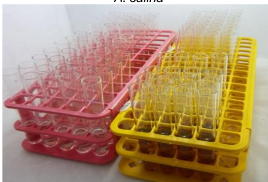
Figura 10 - Foto das diluições das amostras, em tubos, para a realização do ensaio de ecotoxicidade em A. salina
