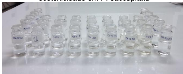
Figura 16 - Foto das diluições de uma das amostras, em vials, para realização do ensaio de ecotoxicidade em P. subcapitata
