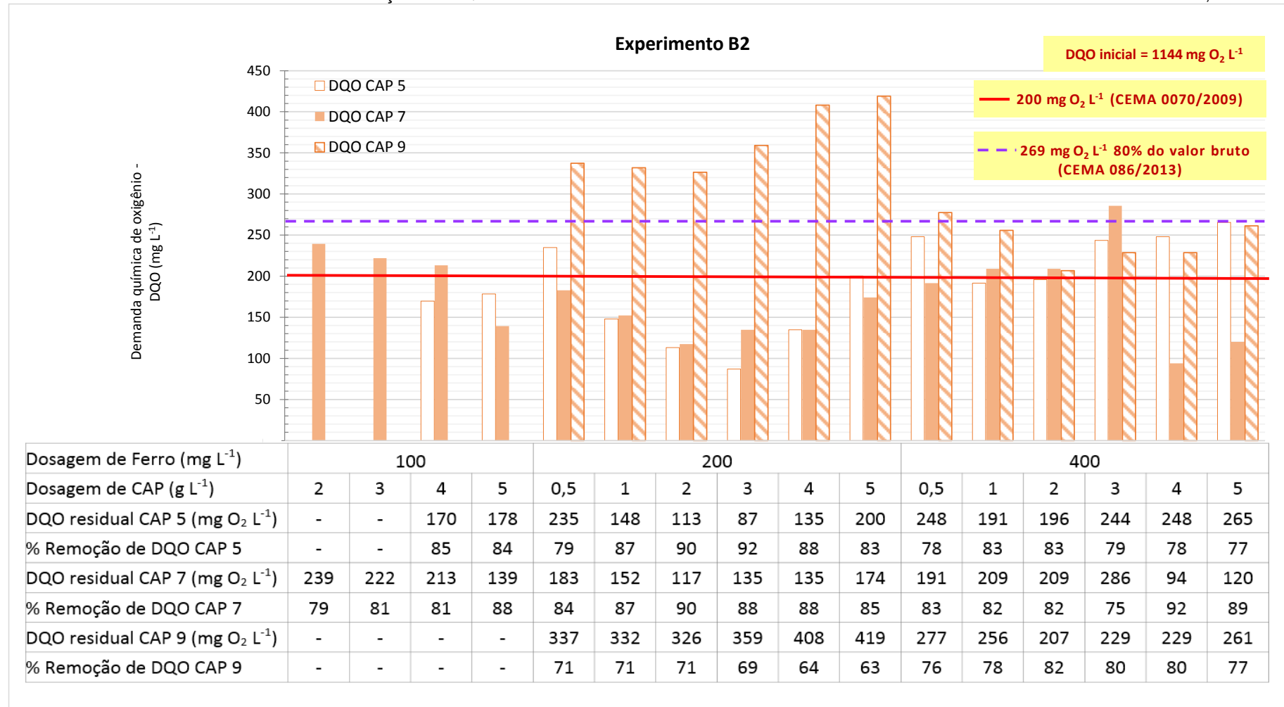
Gráfico 5 - Valores residuais e % de remoção de DQO com resultados de cor verdadeira residual abaixo de 75 uH dos CAPs selecionados 5, 7 e 9
