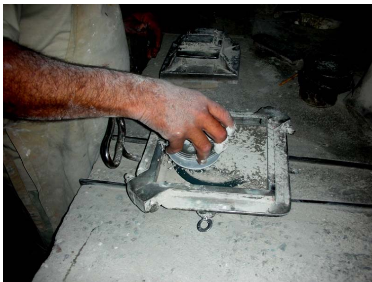
Figura 29 – Secante sendo pulverizado sobre a calda pigmentada
