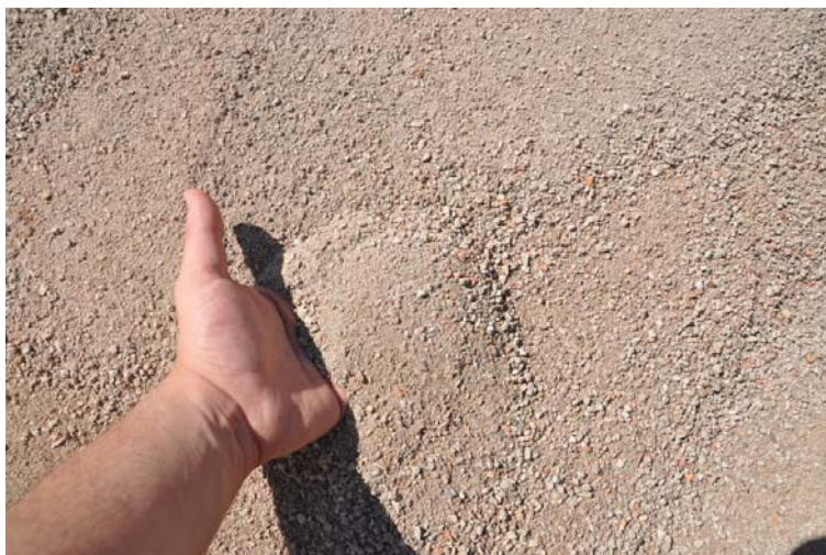
Figura 46 – Areia artificial de RCC reciclados
