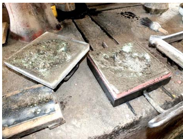
Figura 65 - Desagregação do ladrilho com raspas de borracha no momento da desforma
