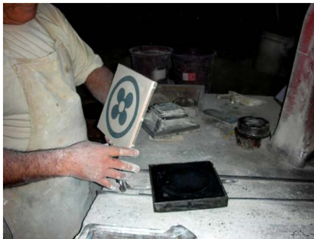
Figura 38 – Ladrilho sendo inspecionado após a desforma
