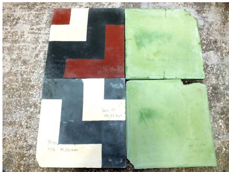
Figura 66 - Ladrilhos hidráulicos com utilização de raspas de borracha de pneus em sua composição
