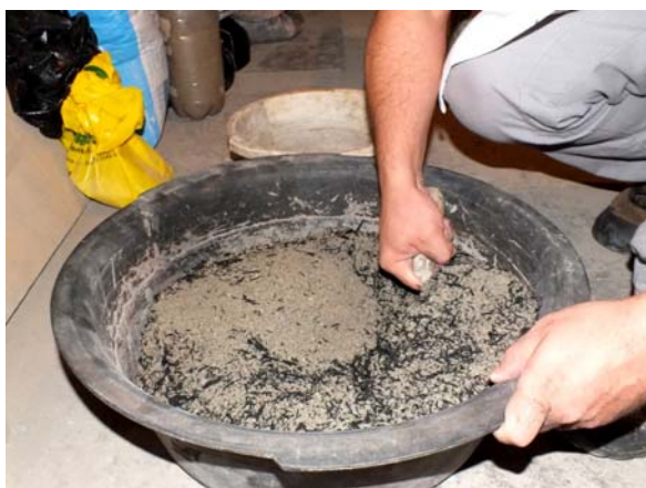
Figura 64 - Mistura com raspas de borracha de pneus para composição da camada do tardo do ladrilho hidráulico
