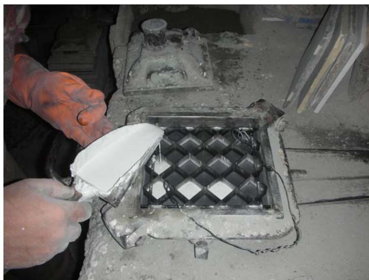
Figura 25 - Calda branca sendo lançada no molde para formação do desenho da superfície do ladrilho
