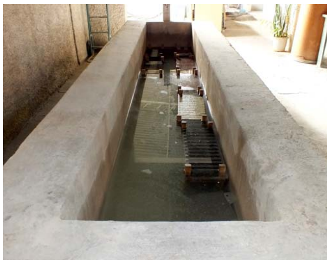
Figura 41 – Tanque onde são dispostos os ladrilhos hidráulicos para a cura das peças
