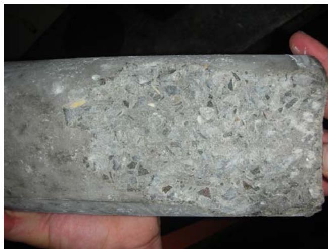
Figura 52 – Corpo de prova rompido após ensaio de compressão
