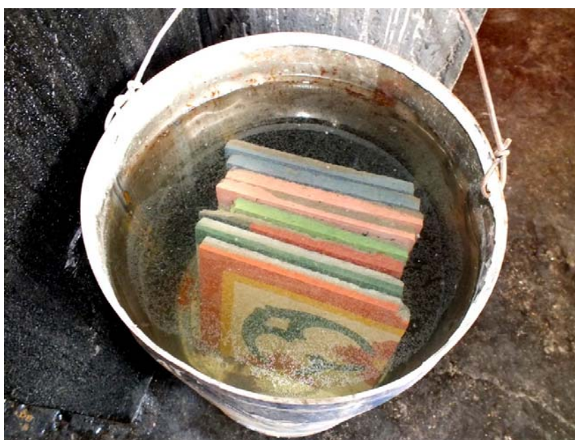
Figura 20 - Ensaio de absorção dos ladrilhos hidráulicos
