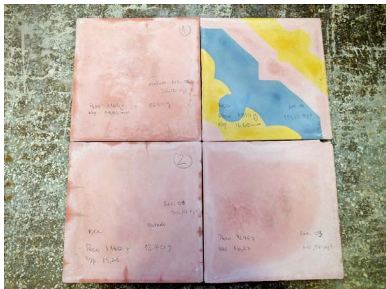
Figura 63 - Ladrilhos produzidos com areia de RCC reciclado
