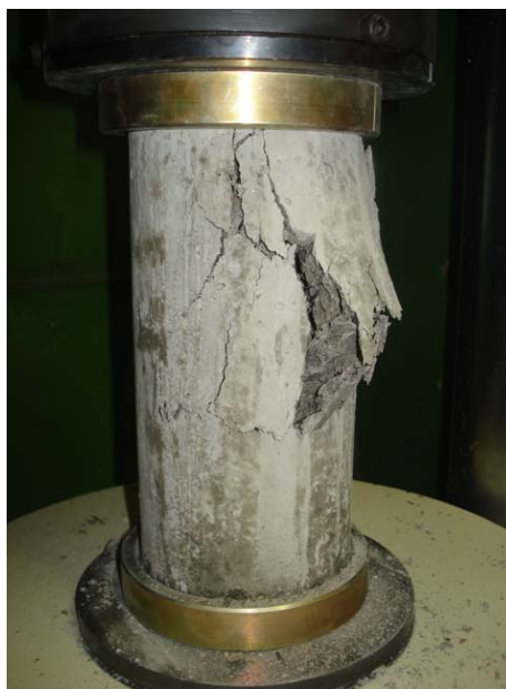
Figura 47 – Corpo de prova rompido no ensaio de compressão axial
