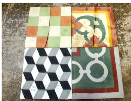
Figura 75 - Ladrilhos após a realização dos ensaios de flexão
