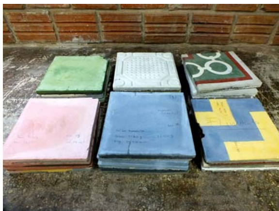
Figura 67 - Peças submetidas à verificação em ensaio dimensional.
