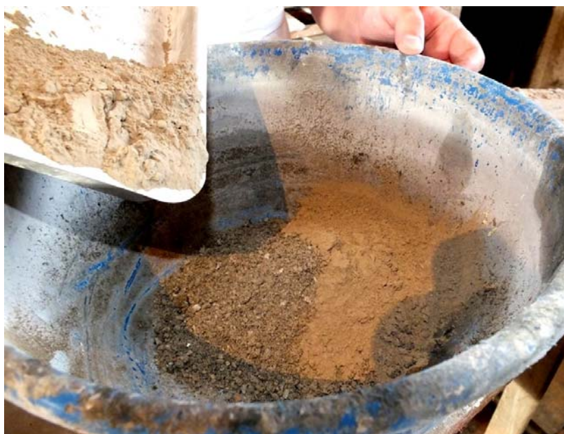
Figura 60 – Substituição de 15% da massa de areia pelo resíduo de pó de britagem
