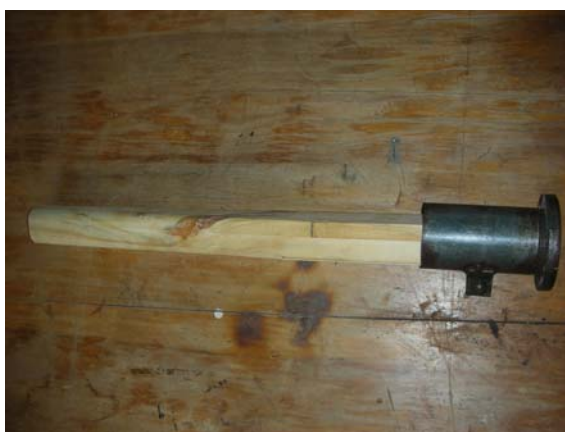
Figura 59 – Soquete desenvolvido para compactação do material seco
