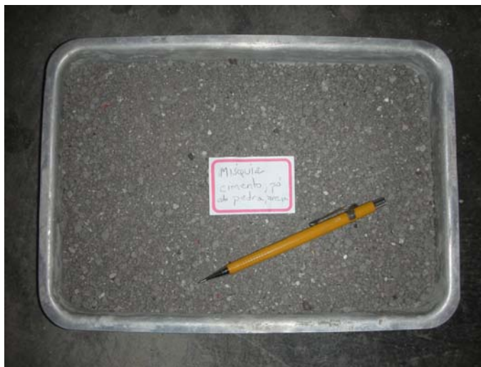
Figura 58 – A “mescla”: material que constitui o tardo do ladrilho hidráulico
