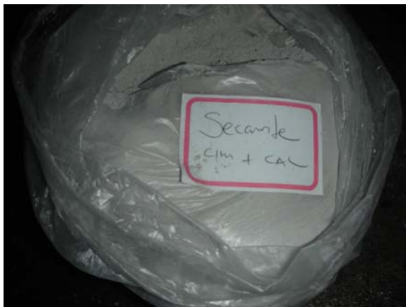
Figura 56 – Amostra de material “secante” recolhido em visita técnica à Fábrica
