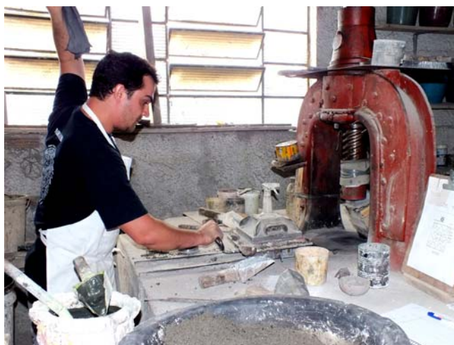
Figura 35 – Movimento da prensa para compactação do material na fôrma
