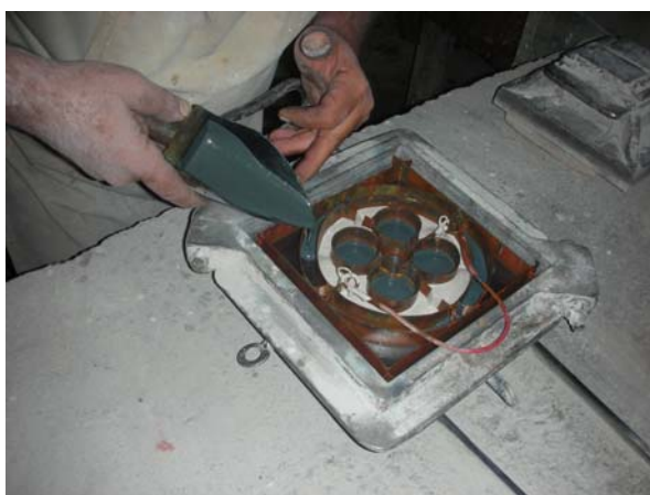
Figura 3 – Preenchimento do molde metálico do ladrilho com a calda pigmentada
