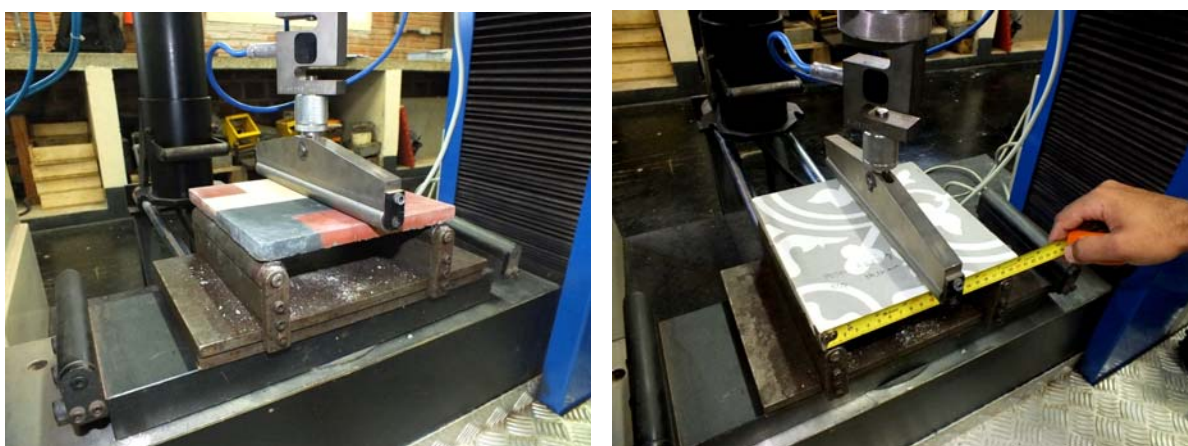
Figura 21 - Ensaio de flexão dos ladrilhos hidráulicos
