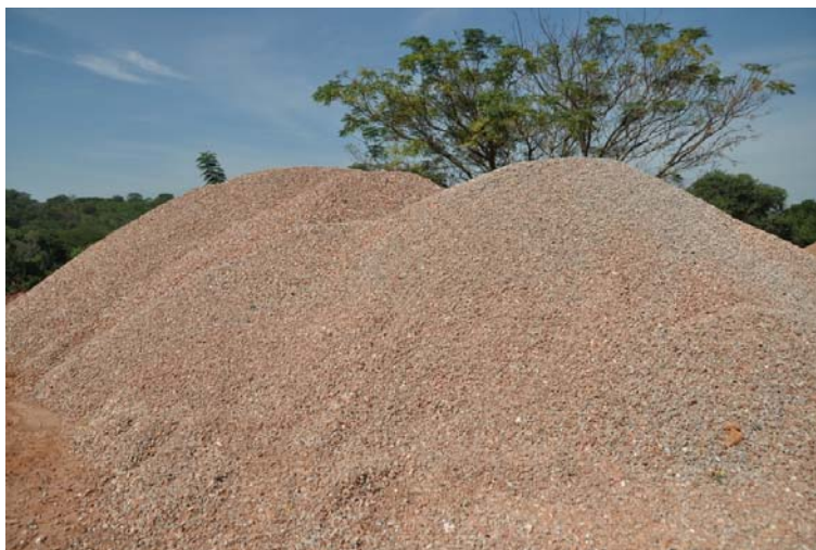
Figura 17 – Agregado da reciclagem de RCC em Londrina
