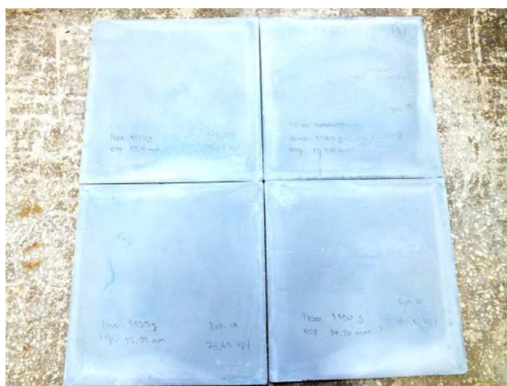
Figura 61 - Ladrilhos hidráulicos produzidos com a incorporação de pó de basalto
