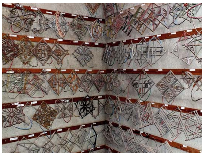
Figura 28 - Distintos moldes utilizados na materialização do design de superfície dos ladrilhos hidráulicos
