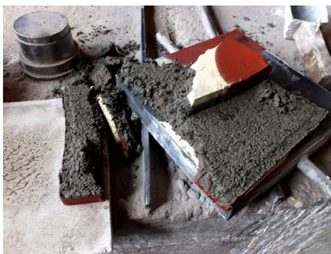
Figura 37 – Peça com excesso de umidade, rompida durante a desforma
