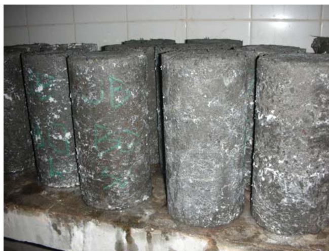
Figura 57 – Corpos de prova com eflorescências
