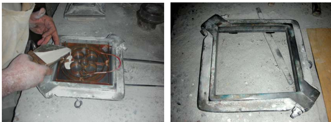
Figura 27 - (a) Fôrma composta pela base, quadro e molde onde se insere a calda e (b) O quadro de ferro fundido que se fecha sobre a base
