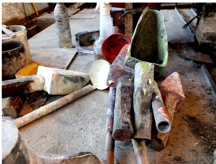
Figura 26 - Algumas ferramentas utilizadas na bancada de produção dos ladrilhos
