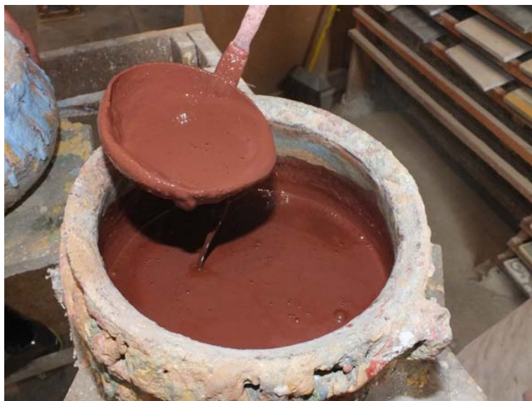
Figura 24 - Calda pigmentada do ladrilho hidráulico
