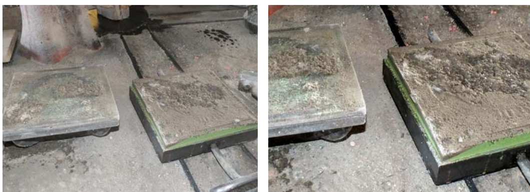
Figura 74 - Desagregação do material após a prensagem do ladrilho hidráulico com incorporação de raspas de borracha de pneus
