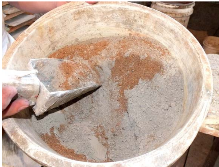
Figura 62 - Mistura para o material secante com areia de resíduos da construção civil reciclados
