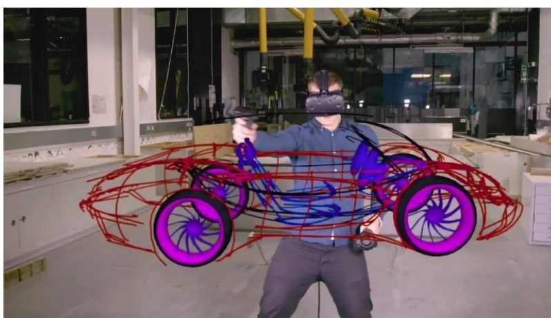
Figura 7 - Esboço criado diretamente no ambiente 3D em RV no software Gravity Sketch
