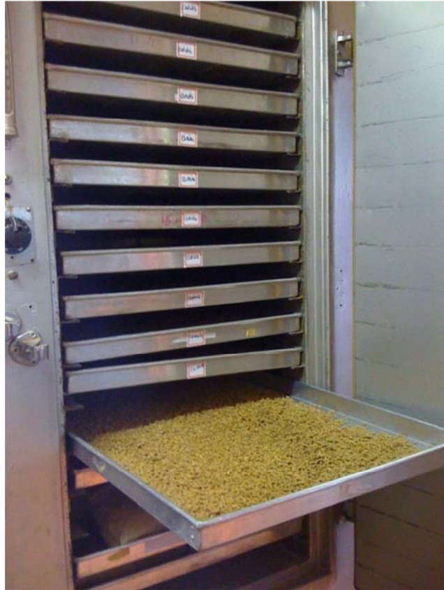
Figura 6 – Secagem das rações experimentais em estufa de circulação forçada de ar.
