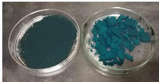
Figura 13 - Material denominado como compósito de PANI/Fe 3 O 4 . Fonte: do autor.
