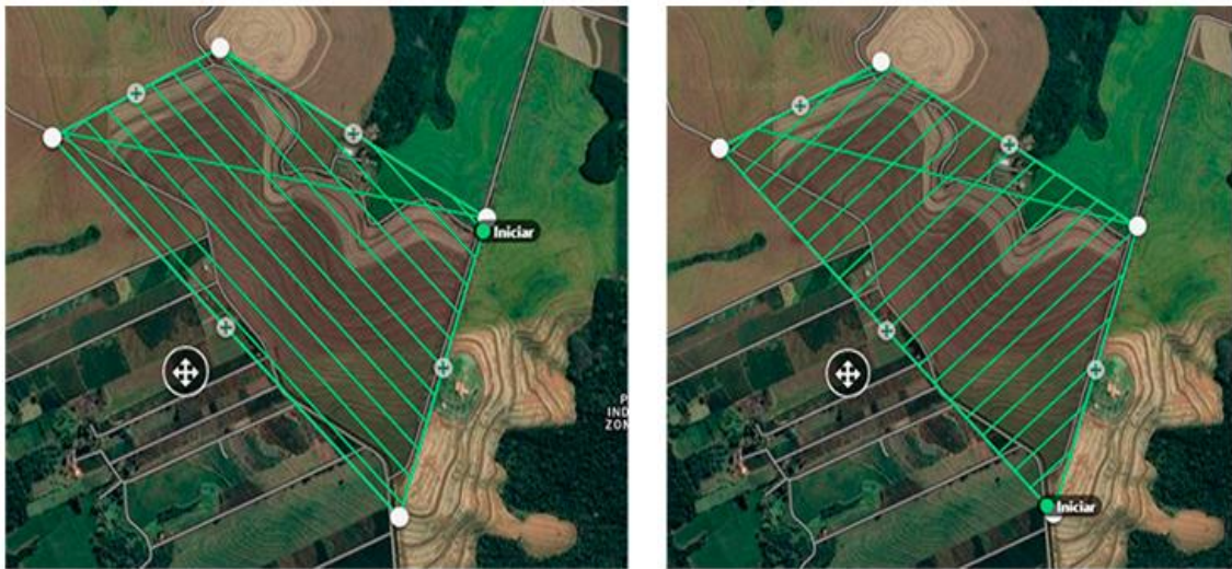
Figura 27: Planos de voo em Double Grid do talhão 2
