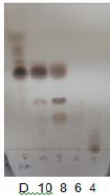
Figura 1 – Cromatografia em camada fina do fracionamento do óleo de C. officinalis . D, fração dicloro. 10,8,6 e 4, pHs da partição ácido-base da fração metanólica. Revelação em sulfato cérico 10% seguido de aquecimento.
