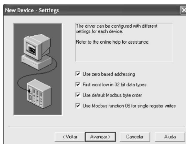
Figura 71 – Criação de um novo nó na rede no software Kepware Server Modbus - etapa 6 - configurar os parâmetros do protocolo Modbus.
