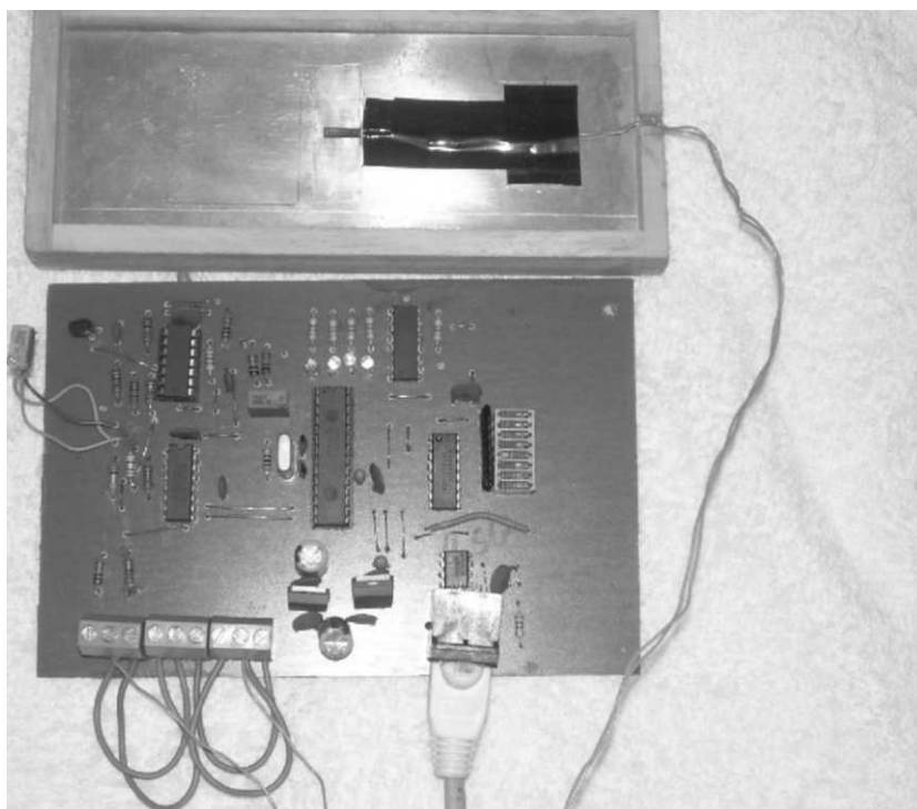
Figura 91 – Extensômetro elétrico ligado em configuração de 1/4 de ponte utilizado para o experimento
