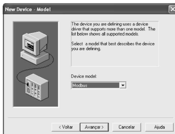
Figura 67 – Criação de um novo nó na rede no software Kepware Server Modbus - etapa 2 - fornecer o protocolo desejado.
