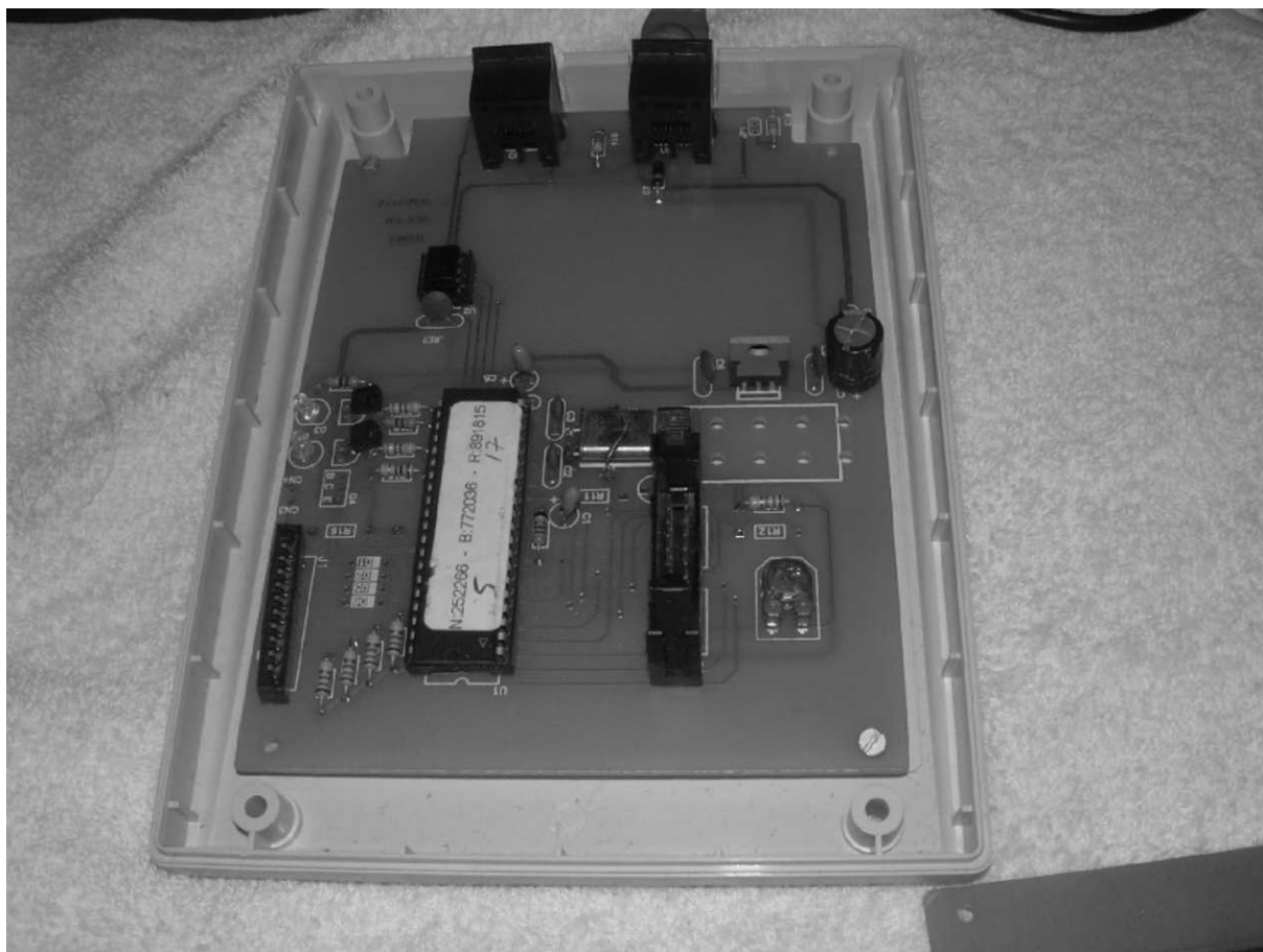
Figura 53 – Fotografia da primeira versão do terminal de rede implementado no microcontrolador AT89S8252 para validação do protocolo MODBUS compilador CCS Versão 4.038.
