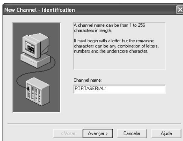
Figura 62 – Criação de um novo canal de comunicação no KEPServerEx - etapa 1 - Fornecimento do nome do canal
