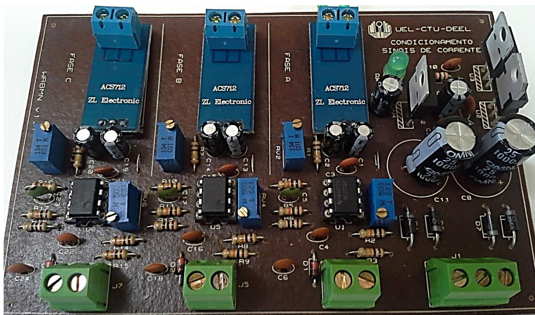
Figura 34: Placa de condicionamento de sinais de corrente.
