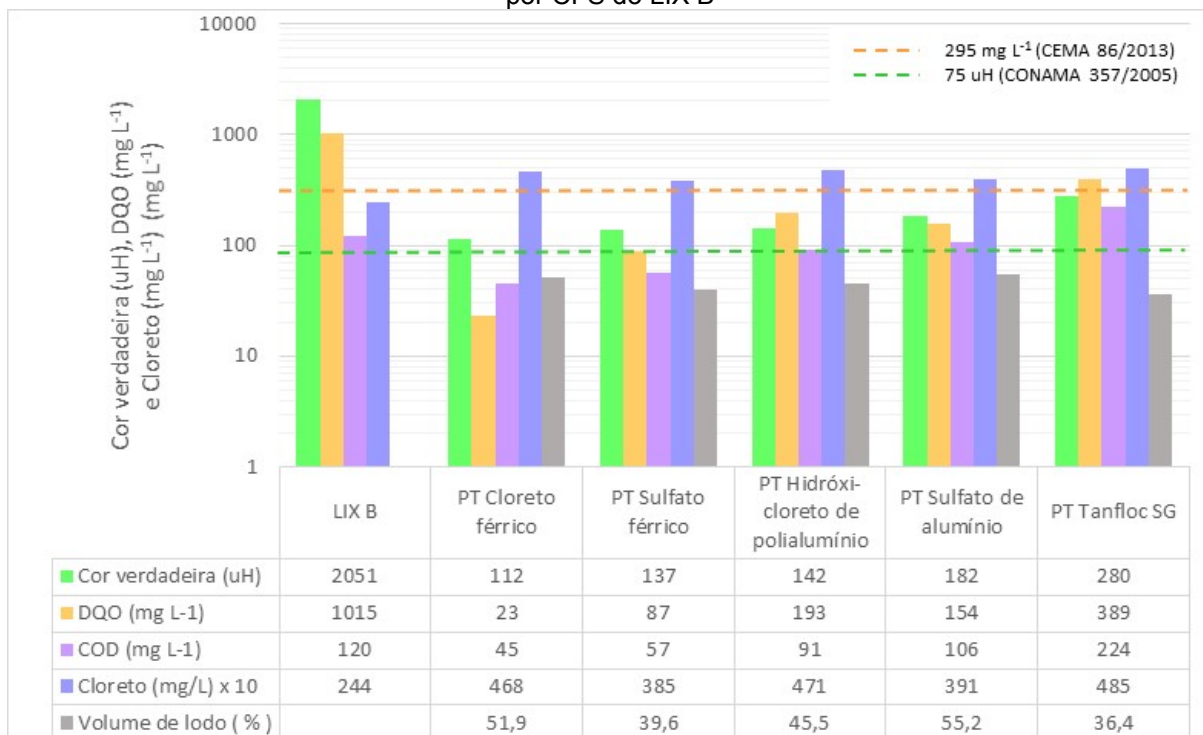
Figura 21 – Valor residual de cor verdadeira, DQO, COD e cloreto após 1h de sedimentação para as condições de maior eficiência de cada coagulante / Experimentos de reprodução do Pós-tratamento por CFS do LIX B
